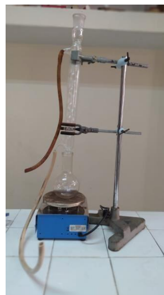
Montage chauffage à reflux
